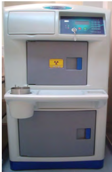
[대용량 밀봉RI( ^{137}\text{Cs} )가 내장된 방사선 조사(Expose)기]
